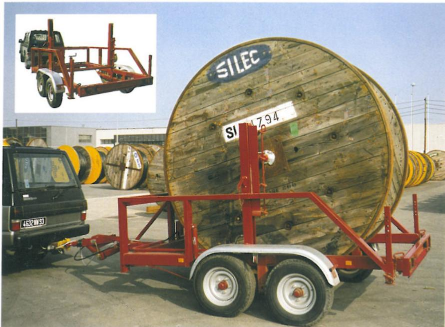
Ce porte-touret a été prévu pour le transport et le déroulage des tourets EDF (exemple : touret bois  $\varnothing$  2,60 m avec 300 mètres de câble MT,  $3 \times 240 \text{ mm}^2 = 2,63 \text{ t}$ ) ou GDF (exemple : touret métal  $\varnothing$  3,10 m avec 160 m de PEHD  $\varnothing$  125).
